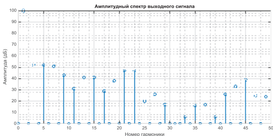
Рис. 14. Выходной амплитудный спектр суммы 8-ми сигналов с фазовым сдвигом 16.1^\circ
