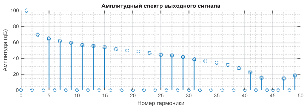
Рис. 25. Спектры амплитуды на выходе УМ при «гладкой» модели нелинейности
