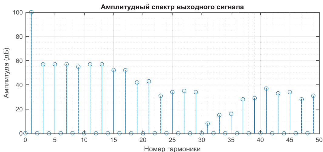
Рис. 21. Выходной амплитудный спектр суммы 4-х сигналов с начальными фазами [0^\circ 25.6^\circ 50.8^\circ 87.8^\circ]
