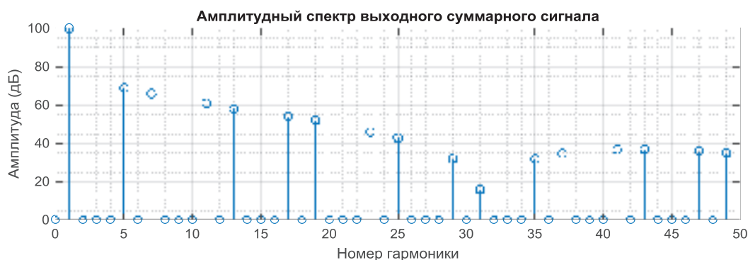
Рис. 6. Выходной амплитудный спектр суммы двух сигналов с начальными фазами 10^\circ и 70^\circ
